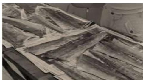
Figura 1. Penúltima etapa do processo de curtimento: secagem
